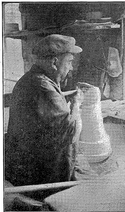
Tournage ou tournassage de la pâte séchée. La pièce est posée sur un plateau horizontal tournant.
