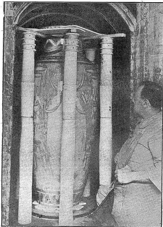
La cuisson des grandes pièces demande des précautions spéciales. Voici un vase de dimensions monumentales, photographié avant sa cuisson dans la partie inférieure, ou laboratoire d'un four.
