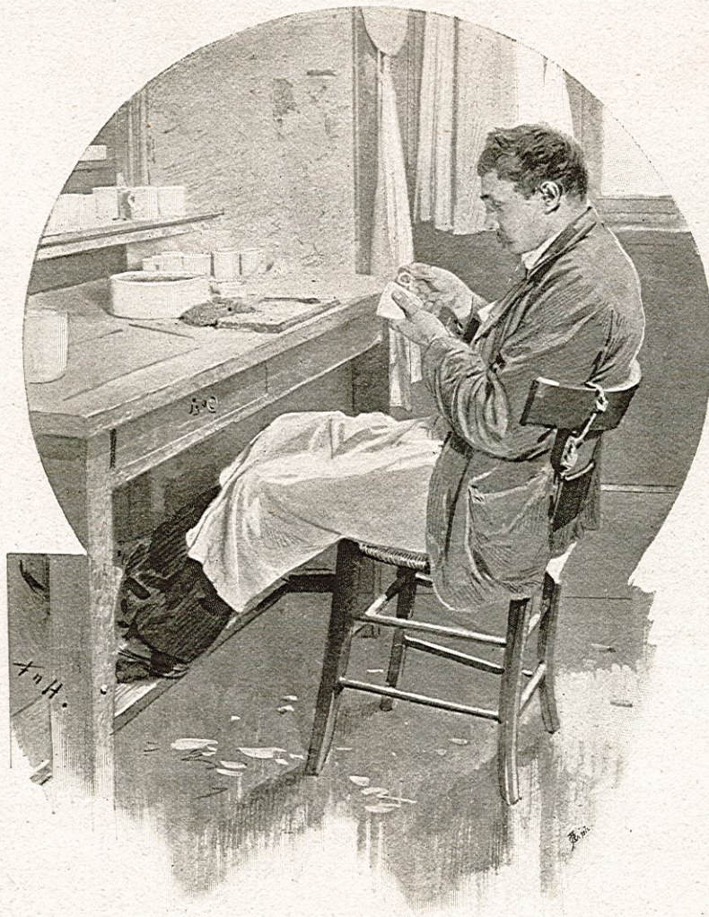
Fabrication des tasses : la pose des anses.
